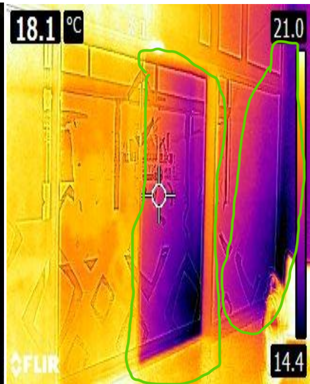
-Puerta interna de acceso Emergencias(P0): Puente térmico entre carpintería, pared y suelo.
