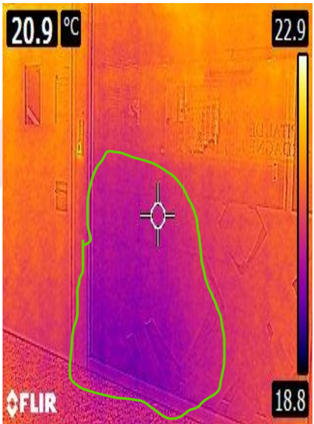
-Puerta interna de acceso Emergencias(P0): Puente térmico entre carpintería, pared y suelo.
